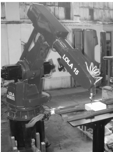
Slika 8. Eksperimentalna verifikacija korišćenjem robota LOLA 15 i simulatora elektrode
