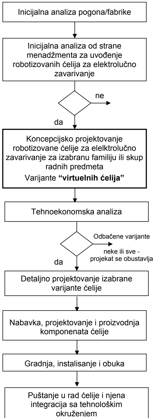
Slika 1. Opšta metodologija projektovanja robotizovanih ćelija na primeru elektrolučnog zavarivanja
